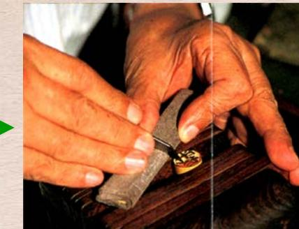
**荒彫り** 印面を起底刀(きていとう)で彫り進めます。
