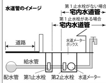
※宅内水道管とは、第1止水栓がある場合には、第1止水栓の後ろから、第1止水栓の後ろから、ない場合には第2止水栓を含めた水道メーターボックスから宅内に敷設された水道管です。
